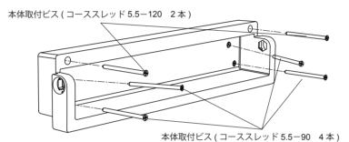
⚠ 注意 取付柱(柱・間柱)に確実に固定して下さい。取付柱の無い壁面への取付けは決してしないで下さい。
